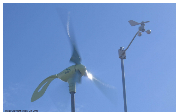
Figure 9.12. Palo che supporta l'anemometro ed il sensore di direzione del vento, in linea con l'altezza del rotore di una turbine eolica – fonte Sigen
