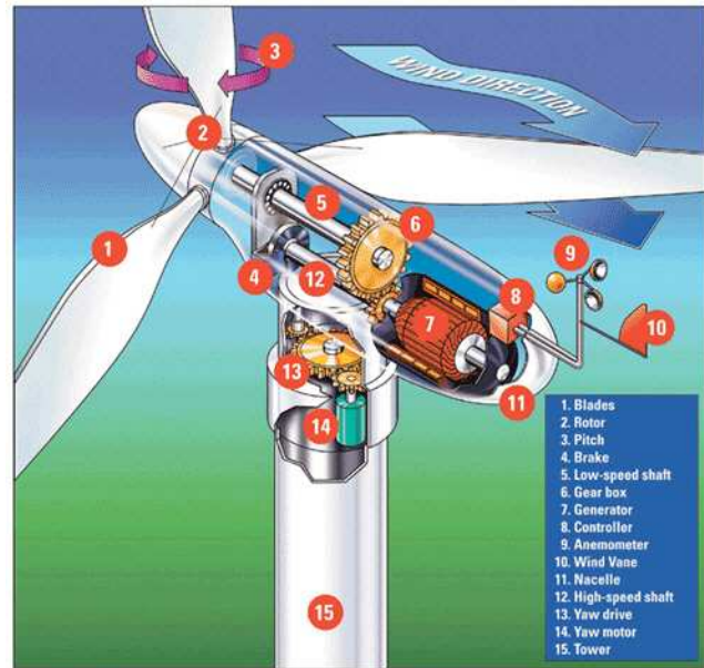
Fig 9.4: Il meccanismo di una turbina eolica – nota bene che questa turbine ha le pale posizionate sopravvento- fonte Alliant Kids Energy
