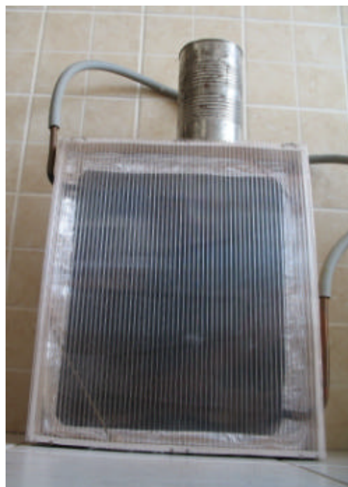
Figure 0 un semplice collettore solare per la sperimentazione a scuola
